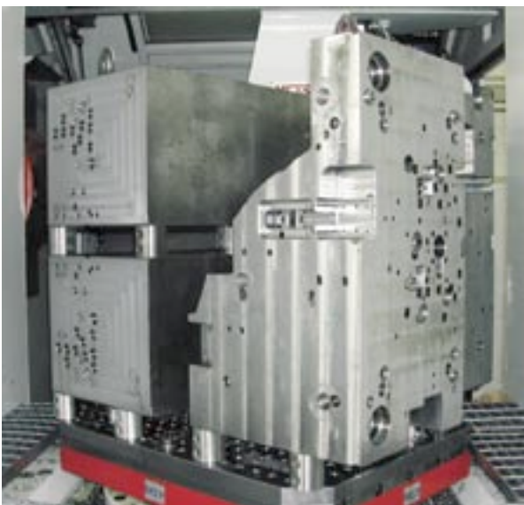
Bild 2: Die Mehrfachbestückung nutzt Maschinenräume ideal aus
