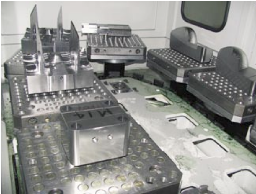
Bild 1: Das Nullpunktspannsystem als Palettensystem zum Erodieren oder Fräsen
