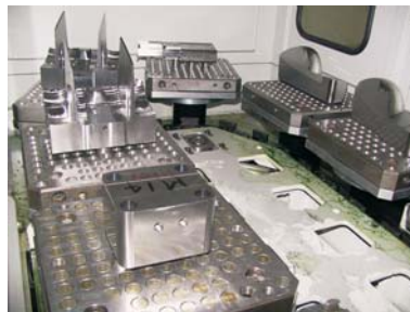
Palettenstrasse im Formenbau
